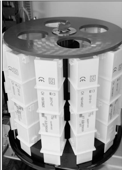
**Figure 58.** Carrossel de cuvette rotativo totalmente carregado
