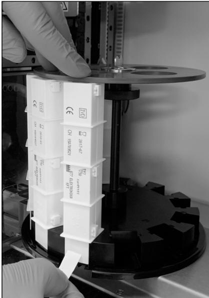
**Figure 57.** Carregamento do cartucho da cuvette rotativa
